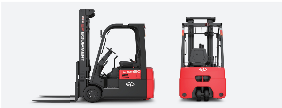
CPD20TVL Longueur jusqu'à la face de la fourche : 1950mm(L2) Largeur hors tout : 1170mm(b1/b2)
